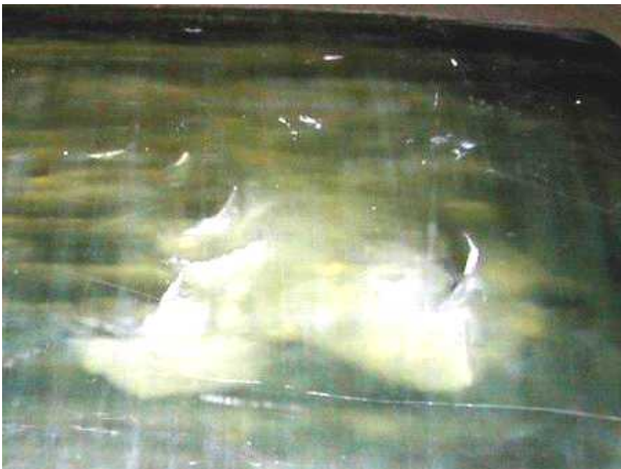
그림 5 표면결함과 연결된 층상박리 - 허용되지 않는 손상
