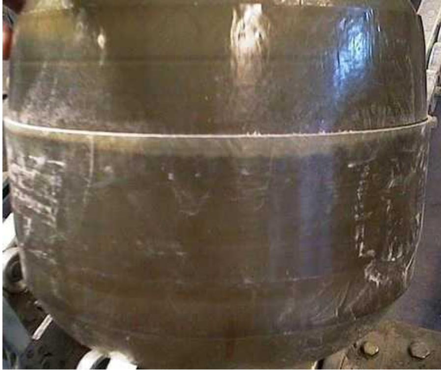
그림 6 접합부에 형성된 공기층 - 공기층의 폭은 15mm 이내이어야 함
