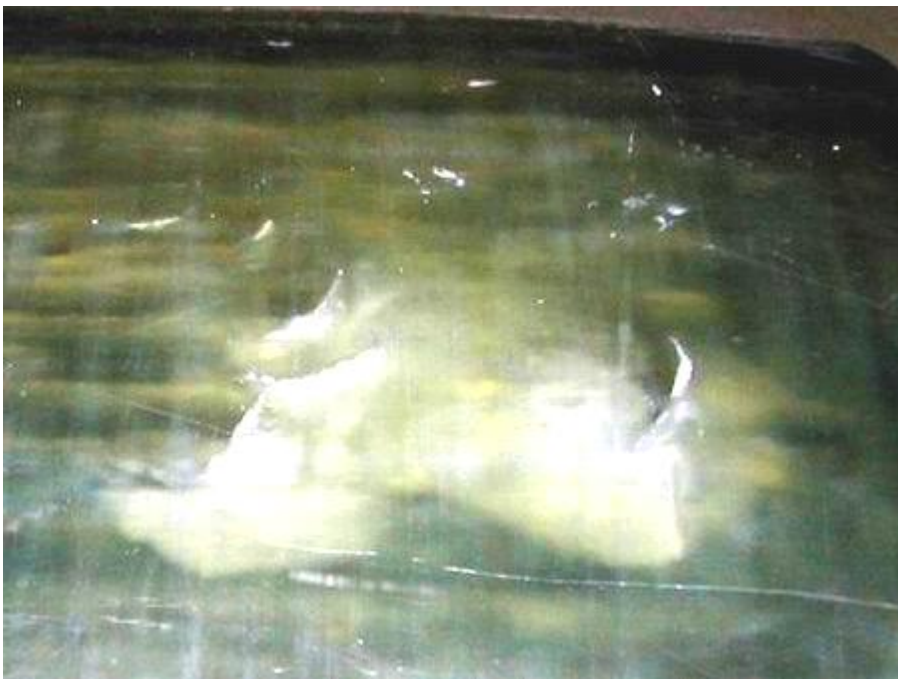
그림 5 표면결함과 연결된 층상박리 - 허용되지 않는 손상
