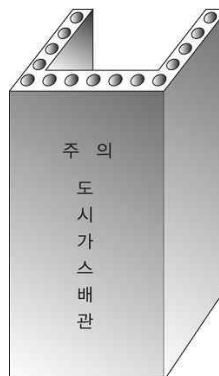
그림 2.5.4.3.3③ “ㄷ” 형태의 철근콘크리트재 방호구조물
