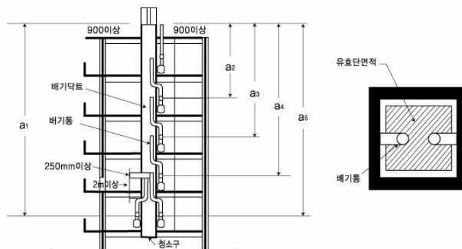
그림 B2.5.1.18 공동배기구의 설치 예시
