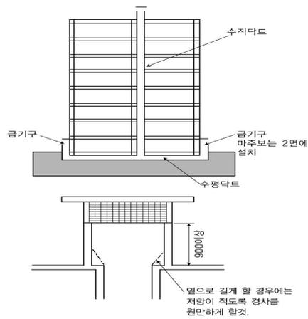
그림 B3.2.3.3.6③ SE덕트의 설치 예시
