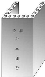
그림 2.5.7.6.9(2)③ “ㄷ” 형태의 철근콘크리트제 방호구조물에 의한 방호조치
