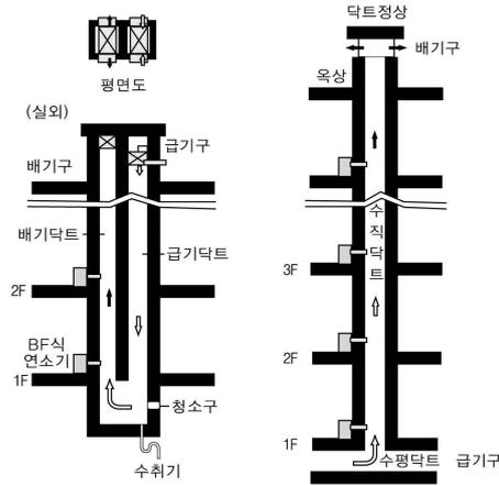
그림 B3.2.3.3.6① SE 및 U덕트의 설치 예시
