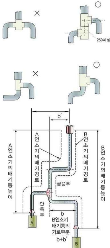
그림 B2.4.6 복합 배기통의 설치 예시
