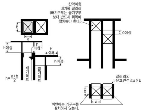
그림 B3.2.3.3.6② U덕트의 설치 예시
