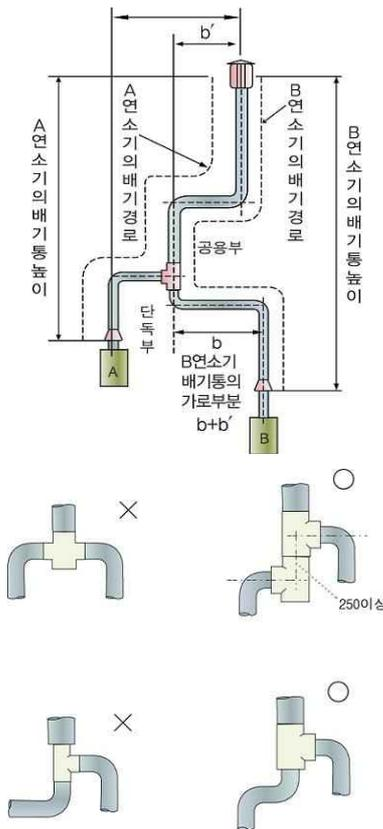
그림 2.7.1.3.1(3) 복합배기통 설치 예
