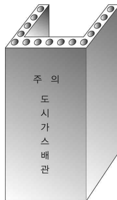
그림 2.5.8.3.1(4)③ “ㄷ” 형태의 철근콘크리트재 방호구조물
