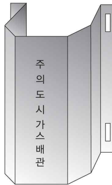
그림 2.5.8.3.1(4)① “ㄷ” 형태로 가공한 방호철판에 의한 방호구조물
