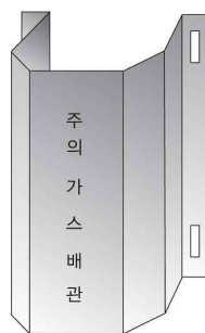
그림 2.5.7.3.2(1) 방호철판을 사용한 방호구조물 예시
