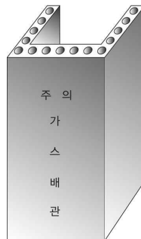
그림 2.5.7.3.2(3) 철근콘크리트제 방호구조물 예시
