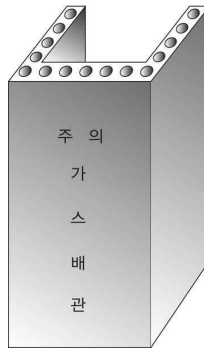
그림 2.5.7.3.2(3) 철근콘크리트재 방호구조물 예시
