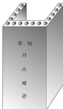
그림 2.5.7.3.2(3) 철근콘크리트제 방호구조물 예시
